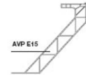
AVP-opstanden, voor een goede isolatie dubbelwandig uitgevoerd
